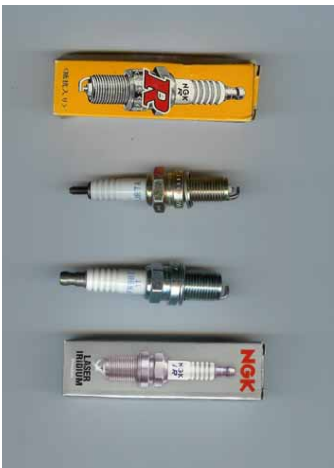
Свечи с платиной (вверху) и иридием (внизу), фирма NRG
